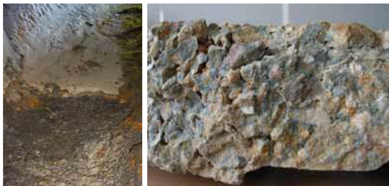
Figuur 9: Effect ijzerhoudend grondwater op infiltratievoorziening
